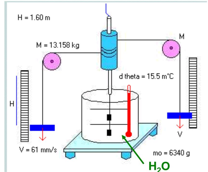
**NB** i  $\Delta T$  sono piuttosto piccoli, l'esperimento è difficile, oggi si usa una resistenza elettrica
