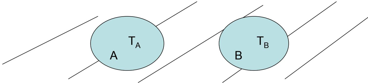
si avrà ancora la stessa temperatura per i due sistemi → **due sistemi, in equilibrio termod. con un terzo, sono in equilibrio fra loro**, formulazione alternativa del principio zero (basta dividere in tre parti A,B,C dove  $T_A = T_B = T_C$  e considerare separatamente le coppie AB,BC e CA)
