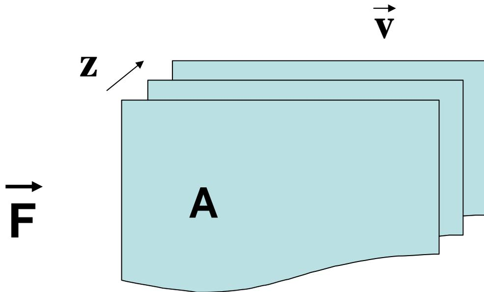
Il coefficiente di proporzionalità  $\eta$  è una caratteristica del fluido ed è detto **viscosità del fluido**.
