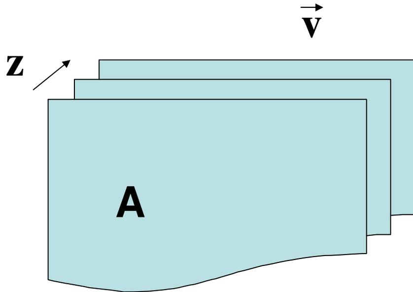
Il coefficiente di proporzionalità  $\eta$  è una caratteristica del fluido ed è detto **viscosità del fluido**.
