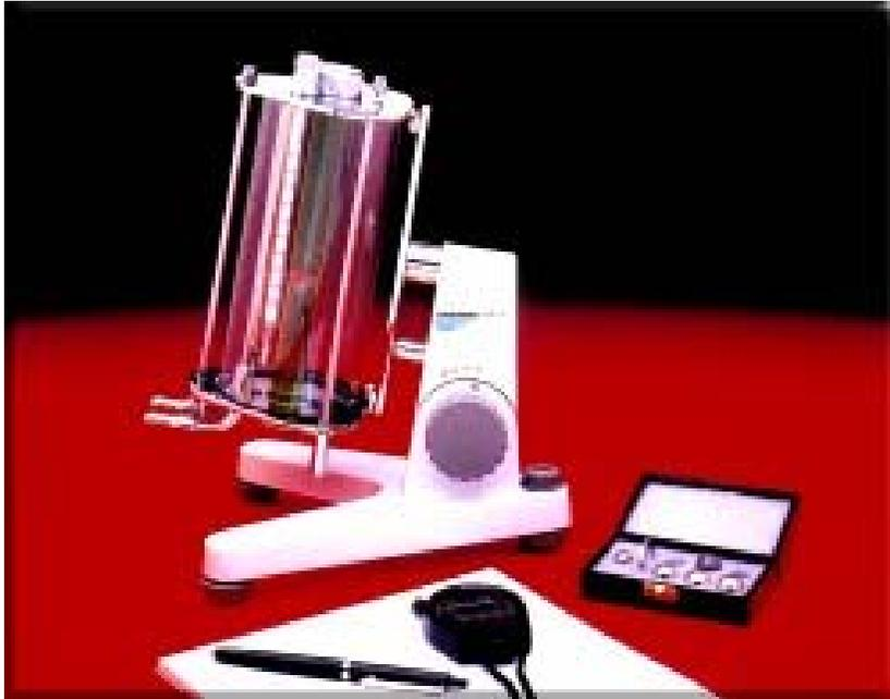
Le dimensioni della sfera sono confrontabili con quelle del tubo di caduta (ottenendo così uno strumento decisamente più maneggevole dei nostri tubi!).
