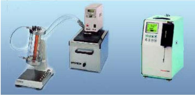
**Esempi di viscosimetri
