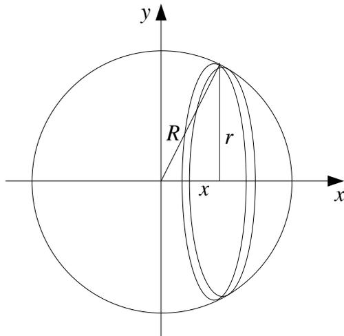
L'elemento infinitesimo di massa che consideriamo è costituito da un disco di raggio  $r = \sqrt{R^2 - x^2}$  e spessore  $dx$ :
