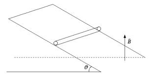
Il sistema è immerso in un campo magnetico stazionario  $\vec{B}$  diretto verticalmente. Calcolare (si trascurino fenomeni di autoinduzione):
