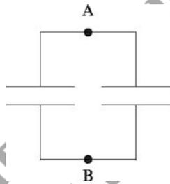
e se nessun altro dispositivo (condensatori, resistenze...) è connesso fra i due punti A e B. In questo caso, e solo in questo caso, i due condensatori sono equivalenti ad un unico condensatore di capacità  $C_{eq} = C_1 + C_2$
